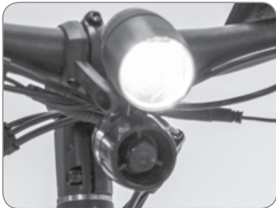
Detailaufnahmen Frontlicht mit der Hupe
