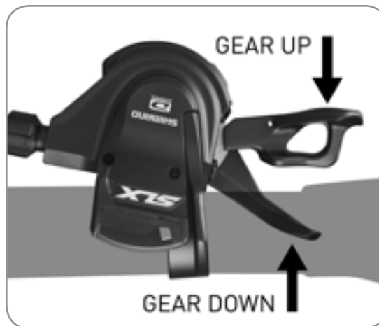
Rapidfire bediening van derailleur versnellingen
