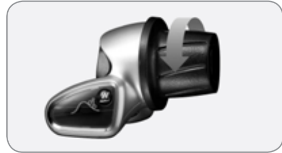
Das Drehschalter von dem NuVinci N380
