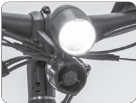
Detailopname voorlicht met daaronder de claxon
