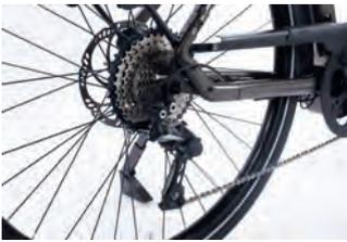
Stark am Heck: Top-Scheibenbremse, 11-fach Kettenschaltung.
