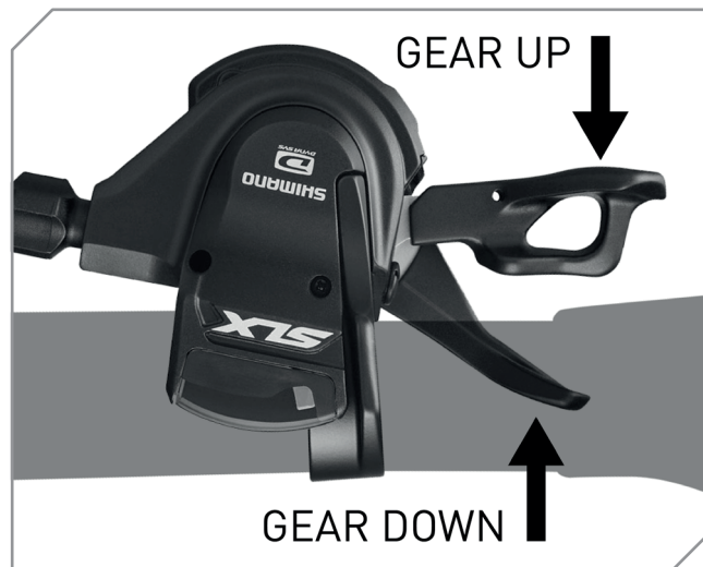
Rapidfire bediening van derailleur en alfine versnellingen
